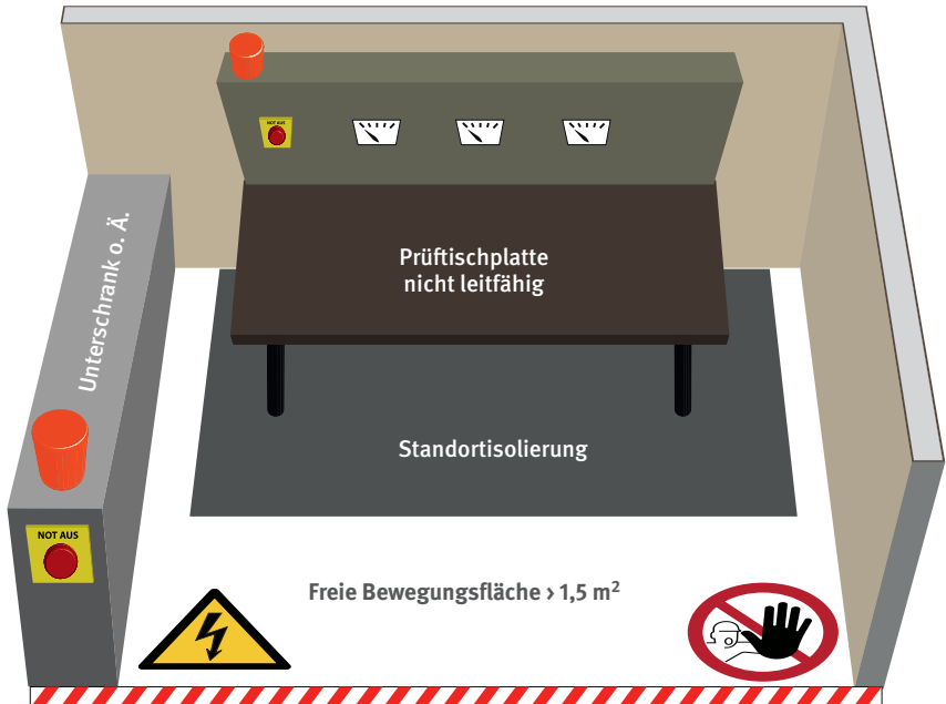
Abb. 6.1 Beispiel für einen Prüfplatz in einer Elektrowerkstatt.
