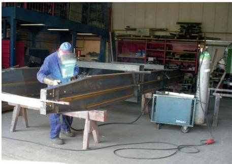
**Abb. 10** Hohe mechanische und thermische Einwirkungen auf die Anschlussleitung des Elektroschweißgerätes
