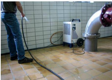
**Abb. 12** Strahlwassereinwirkung auf Anschlussleitung und Betriebsmittel
