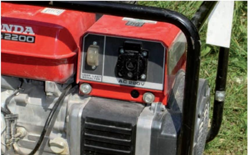
Abb. 7: Ersatzstromerzeuger kleiner Leistung zum Anschluss nur eines Verbrauchsmittels
