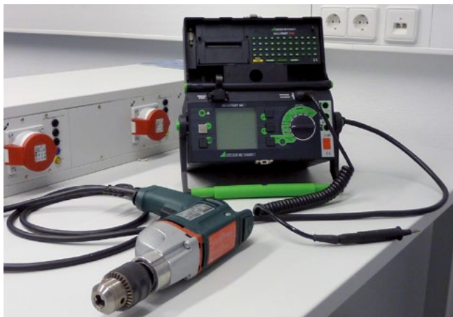
Bild 5-35: Prüfgerät für die Prüfung ortsveränderlicher elektrischer Betriebsmittel
