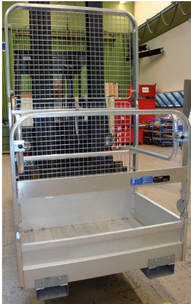
Bild 6-2: Beispiel einer Arbeitsbühne für Gabelstapler
