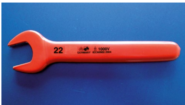
Bild 5-6: Vollisolierter Einmaulschlüssel für Arbeiten bis 1000 V
