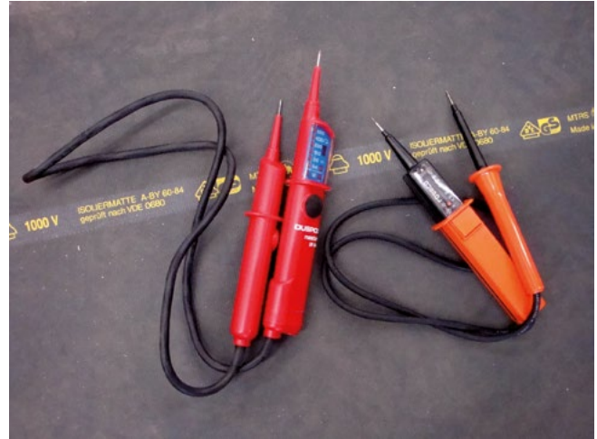
Bild 5-14: Vorschriftenmäßige Spannungsprüfer zur Feststellung der Spannungsfreiheit im Niederspannungsbereich
