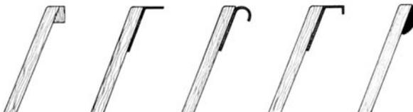
Bild 30: Aufsetz-, Einhak-, Einhängenvorrichtung
