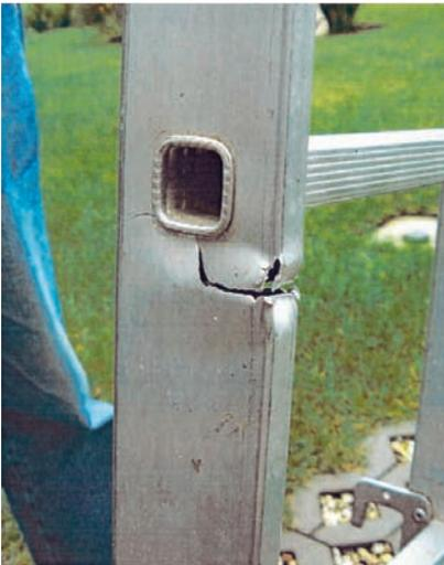
Bild 51: Stark beschädigte Leiter
