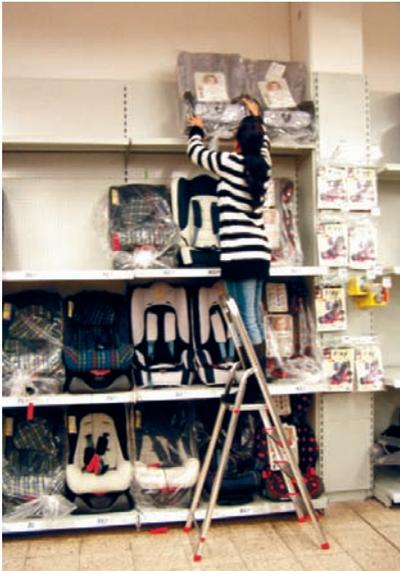
Bild 10: Stufenstehleiter mit Plattform
