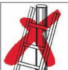
*Unsichere Anlegestellen sind z.B. Glasscheiben, Spanndrähte, Masten, Stangen, unverschlossene Türen.*
