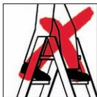
*Die beiden oberen Stufen-/Sprossenpaare dienen dem Anlehnen und ermöglichen so einen sicheren Stand auch ohne separate Haltevorrichtung.*
