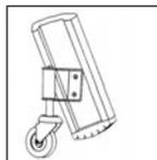
Bild 49: Federgelagerte Fahrrolle
