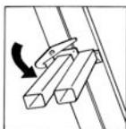
*Bei der Benutzung von höhenverstellbaren Leitern (Schiebe-, Mehrzweck- und Stehleitern) müssen die Fallhakensicherungen eingelegt sein.*
