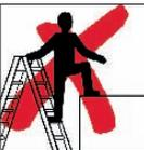
*Beim Übersteigen besteht erhöhte seitliche Kippgefahr.*
